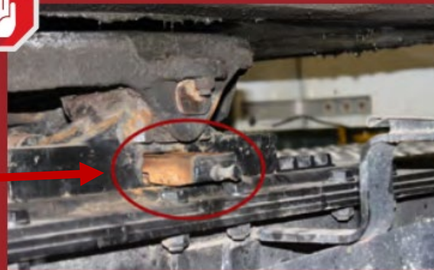
FIGURE 8 | La goupille de blocage de la sellette d'attelage est inopérante parce qu'elle n'est pas en position bloquée.
